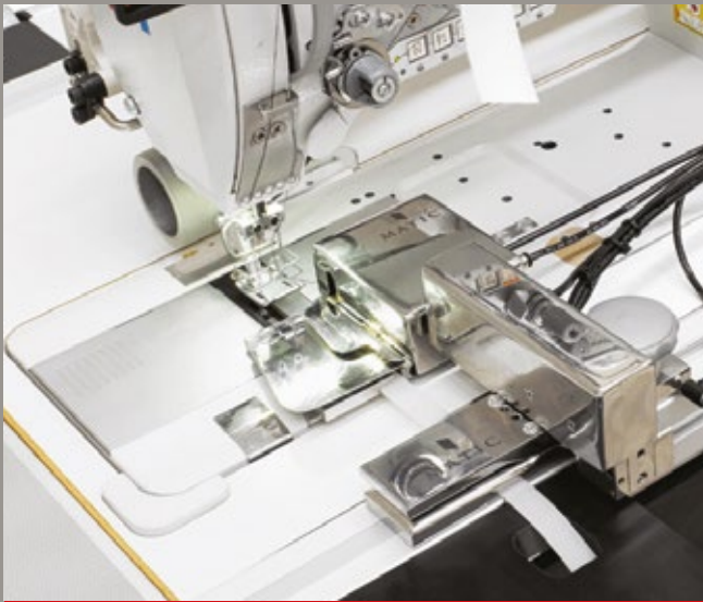
Système d'avancée et de coupe automatique
